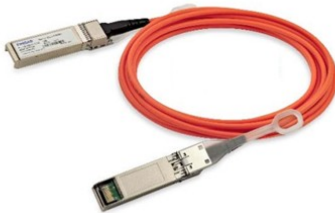
图4-25 25GE AOC 线缆示意图
